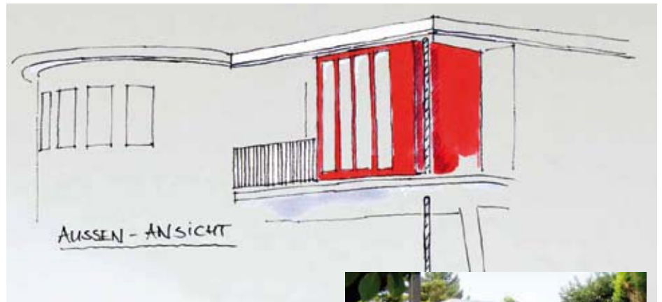
Die Außensauna auf dem Balkon wird durch ein zusätzliches Vordach harmonisch in die bestehende Architektur integriert
